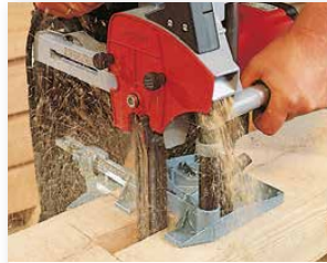
Der LS 103 Ec mit dem Führungsgestell FG 150 für Stemmtiefen bis 140 mm.
