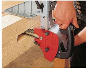
Der LS 103 Ec in horizontalem Arbeitseinsatz.
