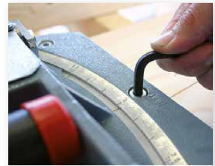
Das Schlitzgerät kann beidsei- tig bis 45° geschwenkt werden.
